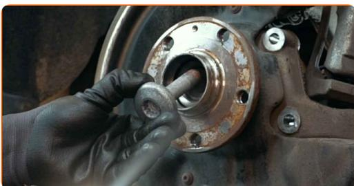
**22** Retirez le moyeu et le roulement puisqu'ils forment un bloc hermétique.
