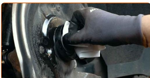
**24** Installez le nouveau moyeu de roue avec un roulement. Servez-vous d'un coffret de douilles et de roulements. Servez-vous d'un marteau.
