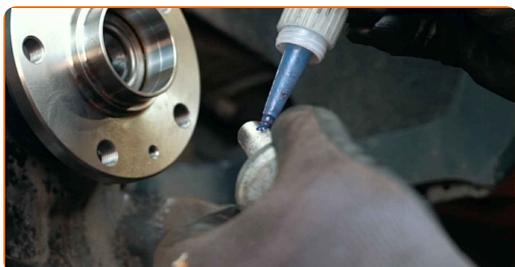
**26** Installez l'écrou de fixation.
