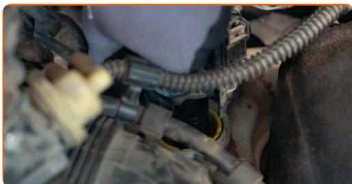
**43** Installez le support de l'électrovanne du moteur. Utilisez la mèche Torx T27. Utilisez une clé à cliquet.
