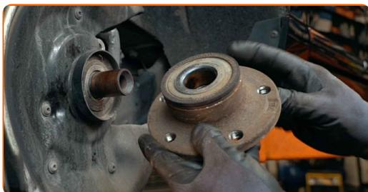
**23** Nettoyez l'emplacement de roulement de moyeu. Utilisez une brosse métallique. Servez-vous d'un aérosol nettoyant multi-usages.
