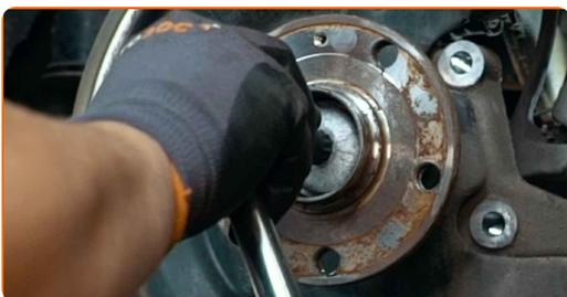
**21** Retirez l'écrou de fixation.
