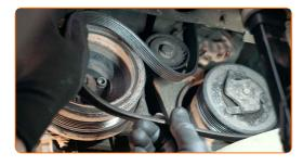
Replacez la poulie du tendeur à sa position initiale. Utilisez une clé mixte de No.16
