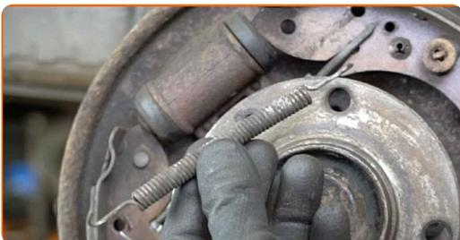
**18** Retirez les éléments de retenue des mâchoires de frein à tambour. Utilisez un compresseur de ressort de frein.
