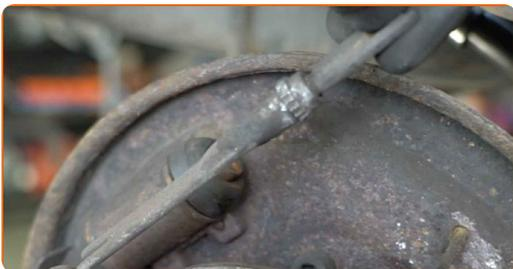
**21** Retirez le ressort de retenue du frein de stationnement de la mâchoire de frein gauche. Utilisez un tournevis plat.
