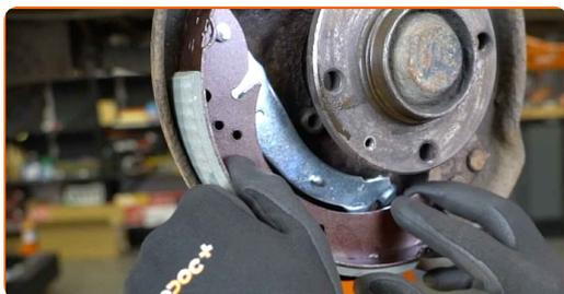
**28** Retirez les éléments de retenue des mâchoires de frein à tambour. Utilisez un compresseur de ressort de maintien de mâchoire de frein.
