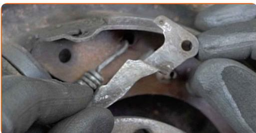
**16** Desserrez le dispositif de réglage de la mâchoire de frein. Utilisez un tournevis plat.
