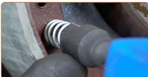
**29** Installez le dispositif de réglage des mâchoires de frein.
