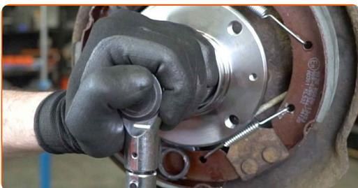
**25** Ressertissez l'écrou de retenue du moyeu de roue. Servez-vous d'un poinçon effilé. Servez-vous d'un marteau.
