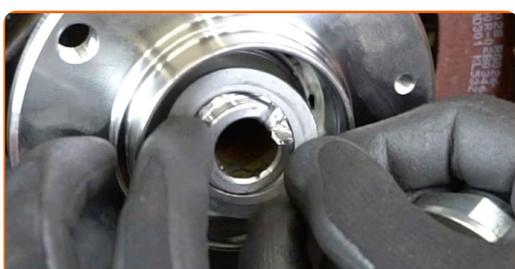
**23** Installez l'écrou de fixation.
