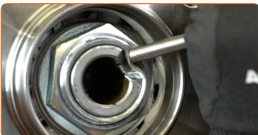
**26** Installez le bouchon de protection du moyeu de roue. Utilisez un coffret de douilles et de roulements. Servez-vous d'un marteau.
