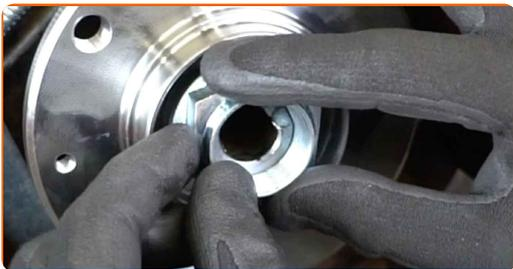
**24** Serrez la fixation du moyeu. Utilisez une douille n° 41. Utilisez une clé dynamométrique. Serrez-le jusqu'à 275 Nm.
