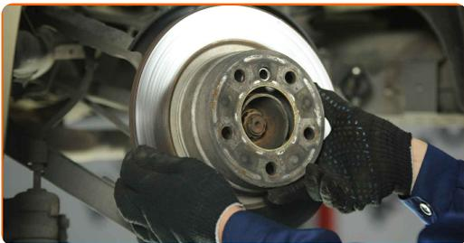
**20** Nettoyez le moyeu. Utilisez une brosse métallique. Traitez la surface de contact. Utilisez de la graisse au cuivre.
