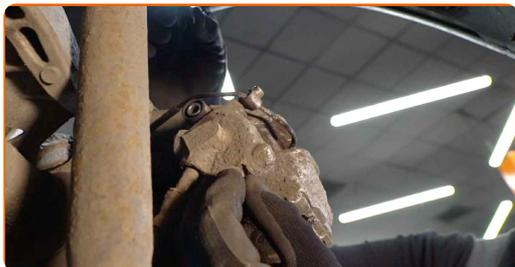
**28** Appliquez du produit sur les boulons de serrage. Utilisez une brosse métallique. Utilisez un enduit.
