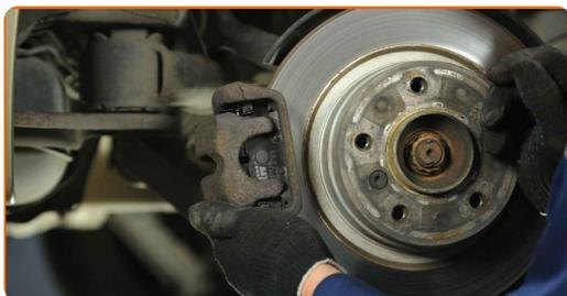
Remplacement : disques de frein – BMW 1 3 portes (E81). AUTODOC recommande :
