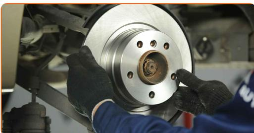
**22** Serrez l'attache du disque de frein. Utilisez la clé HEX n° H6. Utilisez une clé dynamométrique. Serrez-le jusqu'à 16 Nm.
