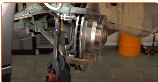
**32** Installez les clips de retenue des plaquettes de frein.
