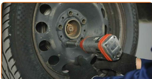
**41** Abaissez la voiture et serrez les boulons de roue en ordre croisé. Servez-vous d'une douille à choc pour roue N°17. Utilisez une clé dynamométrique. Serrez-le jusqu'à 120 Nm.
