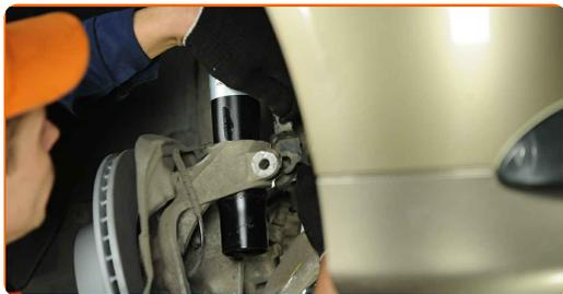
**58** Serrez les fixations inférieures qui relient l'amortisseur à la fusée d'essieu. Utilisez une clé mixte de No.18 Utilisez une douille n° 18. Utilisez une clé dynamométrique. Serrez-le jusqu'à 81 Nm.
