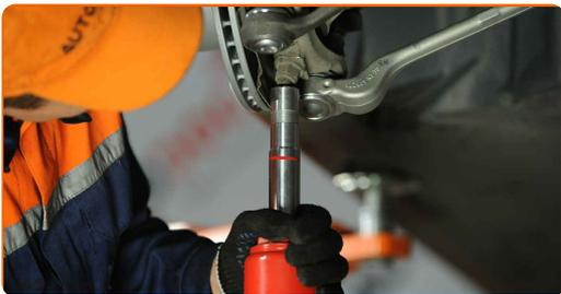
**68** Serrez la fixation avant reliant le bras de commande au sous-châssis. Utilisez une clé mixte de No.18. Utilisez une clé dynamométrique. Serrez-le jusqu'à 68 Nm.+90°
