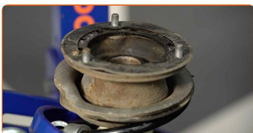
**45** Serrez l'écrou de l'entretoise d'amortisseur due la tige de piston. Utilisez une douille n° 21. Utilisez une clé dynamométrique. Serrez-le jusqu'à 64 Nm.
