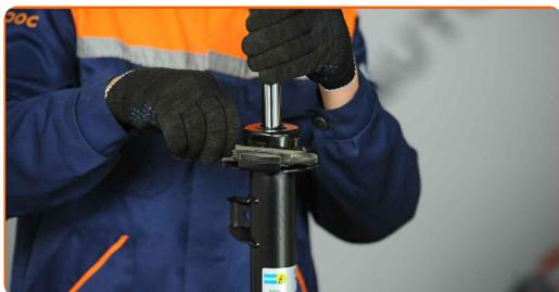
**40** Installez le nouvel amortisseur sur le compresseur à ressort hydraulique hélicoïdal.
