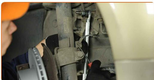
**49** Installez la fixation arrière du bras de commande.
