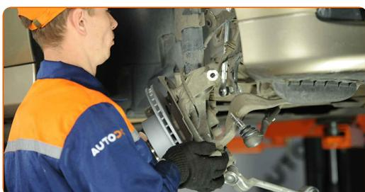
**46** Installez l'écrou de fixation.
