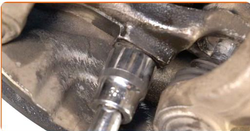
**57** Serrez la fixation avant reliant le bras de commande au sous-châssis. Utilisez une clé mixte de No.18. Utilisez une clé dynamométrique. Serrez-le jusqu'à 68 Nm.+90°
