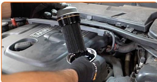
**6** Recouvrez le boîtier du filtre à huile avec un chiffon microfibras pour empêcher aux saletés et à tout objet étranger de pénétrer dans le système.
