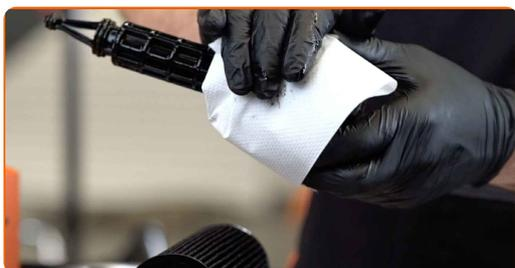
**17** Installez une nouvelle bague d'étanchéité sur l'emplacement du filtre à huile.
