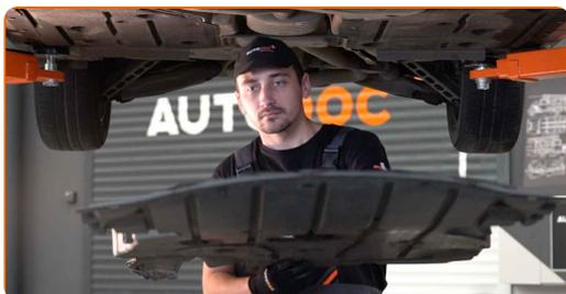
**24** Serrez les fixations du carénage sous moteur. Utilisez une douille n° 8. Utilisez une clé à cliquet.
