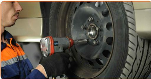
28 Abaissez la voiture et serrez les boulons de roue en ordre croisé. Servez-vous d'une douille à choc pour roue N°17. Utilisez une clé dynamométrique. Serrez-le jusqu'à 120 Nm.
