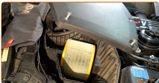
5 Détachez le boîtier du conduit d'air du boîtier du filtre à air. Utilisez un tournevis plat.
