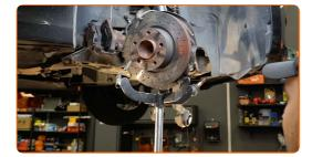
Relâchez la fixation inférieure assurant la connexion entre la jambe d'amortisseur et le porte-fusée. Servez-vous d'une douille spéciale pour retirer l'amortisseur. Utilisez une clé à cliquet.
