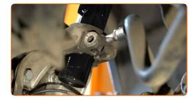
47 Installez l'écrou de fixation.
