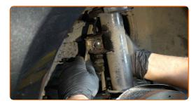
9 Débranchez les fils du capteur d'ABS.
