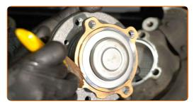
Installez le nouveau moyeu de roue avec un roulement.
