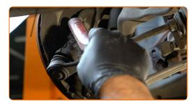
Dévissez l'écrou d'attache d'extrémité à la fusée d'essieu. Utilisez une douille n° 21. Utilisez une clé à cliquet.
