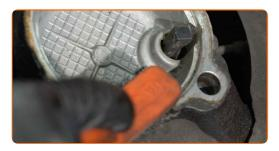
Appliquer un produit sur l'emplacement de montage du moyeu de roue. Utilisez de la graisse au cuivre.
