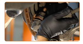
Vissez l'écrou de fixation reliant l'embout de biellette à la fusée d'essieu. Utilisez une douille n° 21. Utilisez une clé à cliquet.
