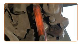
Dévissez l'attache du support d'étrier. Utilisez une douille n° 18. Utilisez un porte-taraud.
