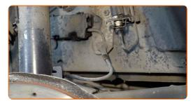
Détachez le connecteur du capteur ABS.
