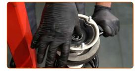
Serrez l'écrou de l'entretoise d'amortisseur due la tige de piston. Utilisez une douille n° 21. Utilisez la clé HEX n° H6. Utilisez une clé dynamométrique. Serrez-le jusqu'à 64 Nm.
