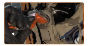
63 Connectez l'extrémité du tirant à la fusée d'essieu.
