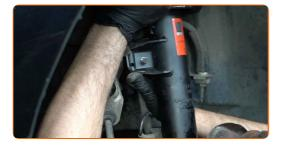
Serrez la fixation reliant la biellette à l'amortisseur. Utilisez une clé mixte de No.18. Utilisez une douille n° 15. Utilisez une clé dynamométrique. Serrez-le jusqu'à 58 Nm.
