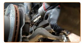
Dévissez l'attache du bras avant. Utilisez une clé mixte de No.18. Utilisez une douille n° 18. Utilisez une clé à cliquet.
