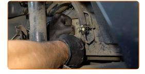
Détachez le connecteur du capteur ABS.
