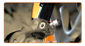
57 Installez l'écrou de fixation.
