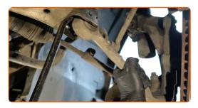
Retirez l'écrou de fixation.
