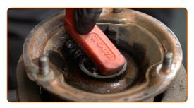
Retirez l'écrou de la tige de piston de l'entretoise. Utilisez une douille n° 21. Utilisez la clé HEX n° H6. Utilisez une clé à cliquet.
