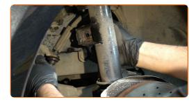
Débranchez les fils du capteur d'ABS.
