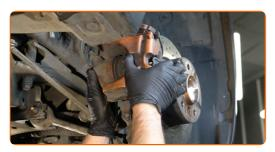
Serrez le support de l'étrier de frein. Utilisez une douille n° 18. Utilisez une clé dynamométrique. Serrez-le jusqu'à 110 Nm.
