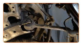
61 Installez les boulons de fixation.
