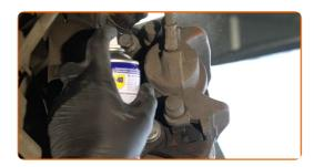
Dévissez l'attache du support d'étrier. Utilisez une douille n° 18. Utilisez un porte-taraud.
