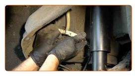
Connectez le connecteur du capteur d'usure de la plaquette de frein.
