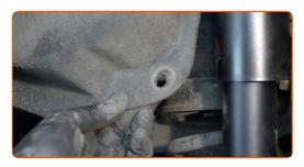
Déconnectez le connecteur du capteur d'usure de plaquette de frein.
