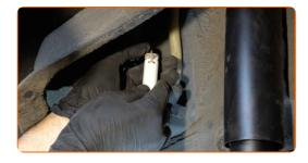
Vissez la garniture de passage de roue. Vissez les fixations. Utilisez une douille n° 10. Utilisez une clé à cliquet.
