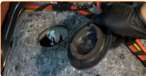
**9** Relâchez la fixation supérieure de l'amortisseur. Servez-vous d'un embout d'amortisseur DDN<sup>®</sup>6. Utilisez une douille n° 16. Utilisez une clé à cliquet.
