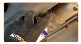
Desserrez le support du filtre à carburant. Utilisez la clé HEX n° H5. Utilisez une clé à cliquet.
