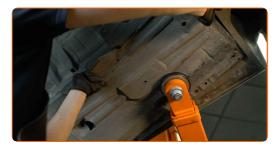
Vissez les fixations du panneau de protection du dessous de caisse. Utilisez une douille n° 8. Utilisez une douille n° 10. Utilisez une clé à cliquet.
