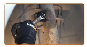
Dévissez la fixation reliant la biellette à la barre stabilisatrice. Utilisez la clé HEX n° H7. Utilisez une clé mixte de No.17 Utilisez une clé à cliquet.
