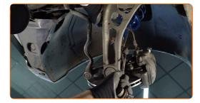
Installez une nouvelle barre, serrez les attaches.
