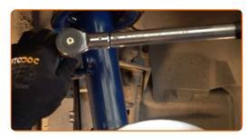
Serrez la fixation reliant la biellette à la barre stabilisatrice. Utilisez une douille n° 17. Utilisez une clé mixte de No.17 Utilisez une clé dynamométrique. Serrez-le jusqu'à 55 Nm.
