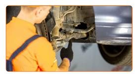
Déserrez l'écrou de bloquage qui retient l'extrémité de la barre stabilisatrice à la barre stabilisatrice. Utilisez une clé mixte de No.24
