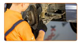
Dévissez l'écrou d'attache d'extrémité à la fusée d'essieu. Utilisez une douille n° 18. Utilisez une clé à cliquet.
