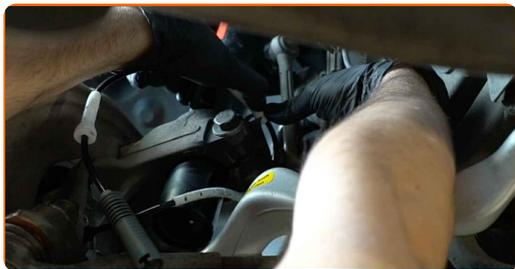
**17** Attachez le connecteur du capteur ABS.
