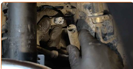
**8** Débranchez les fils du capteur d'ABS.
