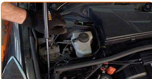
**4** Dévissez le bouchon du réservoir de liquide de frein.
