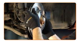
Serrez l'attache du disque de frein. Utilisez la mèche Torx T30. Utilisez une clé dynamométrique. Serrez-le jusqu'à 16 Nm.
