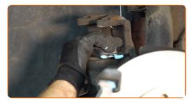
Installez l'étrier de frein et fixez-le. Utilisez la clé HEX n° H7. Utilisez une clé dynamométrique. Serrez-le jusqu'à 30 Nm.
