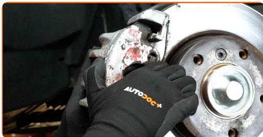
**29** Serrez le support de l'étrier de frein. Utilisez une douille n° 16. Utilisez une clé dynamométrique. Serrez-le jusqu'à 110 Nm.
