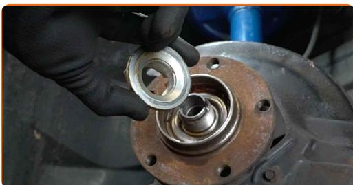
**17** Retirez le moyeu de roue avec les roulements. Servez-vous d'un extracteur d'engrenage à 3 bras.
