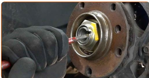
**15** Dévissez l'écrou de moyeu. Utilisez une douille n° 46. Utilisez un porte-taraud.
