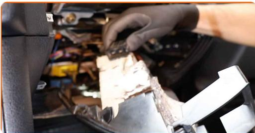
**9** Retirez les fixations du boîtier du conduit d'air. Utilisez un outil d'extraction de clips.
