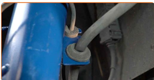
**48** Appliquez du produit sur les fixations de l'amortisseur. Utilisez de la graisse au cuivre.
