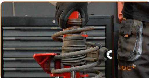
Remplacement : jambe de suspension – BMW 3 Coupe (E36). AUTODOC recommande :
