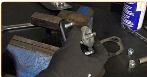
**22** Serrez l'écrou de la tige de l'amortisseur. Utilisez une douille n° 16. Servez-vous d'un embout d'amortisseur DDN°6. Utilisez une clé dynamométrique. Serrez-le jusqu'à 37 Nm.
