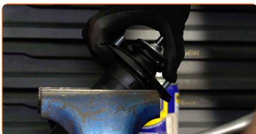
**24** Appliquez du produit sur l'élément de fixation de la tige de l'amortisseur. Utilisez de la graisse au cuivre.
