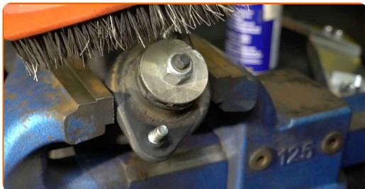
**19** Retirez l'attache de la tige du piston de l'amortisseur. Servez-vous d'un embout d'amortisseur DDN<sup>®</sup>6. Utilisez une douille n° 16. Utilisez une clé à cliquet.
