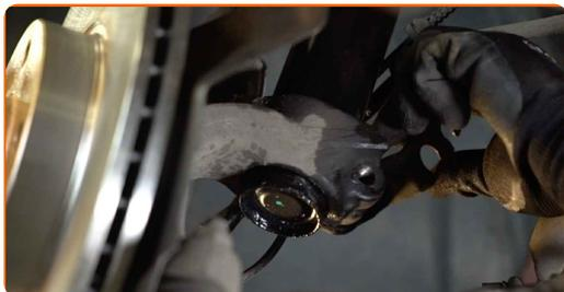
**41** Installez et serrez un nouveau boulon sur la fusée d'essieu.
