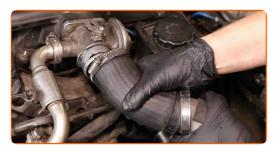
Recouvrez la durite d'admission d'air avec un chiffon microfibre pour empêcher que des particules n'entrent dans le système.
