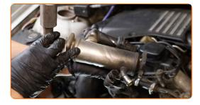
Recouvrez le tuyau du refroidisseur EGR avec un tissu en microfibre afin d'éviter que la poussière ou la saleté ne 28 pénètre dans le système.
