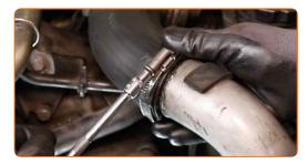
Nettoyez les sièges de montage du tuyau de refroidissement. Servez-vous d'un aérosol nettoyant multi-usages.
