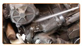
Dévissez les fixations du boîtier du thermostat. Utilisez une douille n° 10. Utilisez une clé à cliquet.
