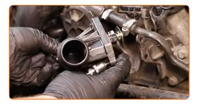
Recouvrez le tuyau du refroidisseur EGR avec un tissu en microfibre afin d'éviter que la poussière ou la saleté ne pénètre dans le système.
