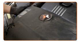
Vissez les fixations de l'ensemble du boîtier de distribution d'air. Utilisez une douille n° 12. Utilisez une clé à cliquet.
