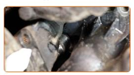
Dévissez les fixations du boîtier du thermostat. Utilisez une douille n° 10. Utilisez une clé à cliquet.
