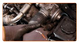
Retirez les colliers de fixations du tuyau de reniflard et du tuyau d'admission du filtre à air. Utilisez une douille n° 7. Utilisez une clé à cliquet.
