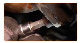
Serrez les fixations du refroidisseur EGR. Utilisez une douille n° 13. Utilisez une clé dynamométrique. Serrez-le jusqu'à 12 Nm.
