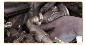
Serrez le collier de serrage du tuyau du refroidisseur EGR. Utilisez une douille n° 7. Utilisez une clé à cliquet.
