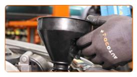
Versez du liquide de refroidissement dans le réservoir.
