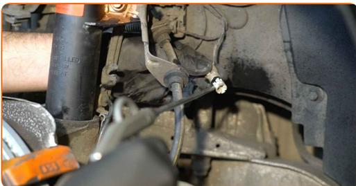
**11** Connectez le connecteur du capteur d'usure de la plaquette de frein.
