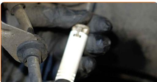
**12** Connectez le capteur d'usure des plaquettes de frein.
