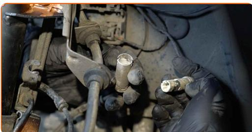
**10** Appliquez du produit sur le bouchon du capteur d'usure des plaquettes de frein. Utilisez de la graisse diélectrique.
