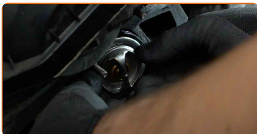
22 Appliquez du produit sur l'emplacement de montage du boîtier du thermostat. Utilisez un enduit.
