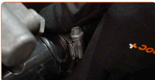
**12** Desserrez le collier de serrage du tuyau de refroidissement. Utilisez une douille n° 7. Utilisez une clé à cliquet.
