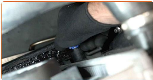
**10** Desserrer les colliers de serrage des tuyaux de refroidissement. Utilisez une douille n° 7. Utilisez une clé à cliquet.
