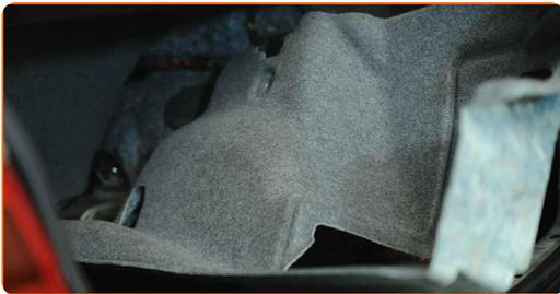
**22** Retirez le bouchon de protection du support de l'amortisseur. Utilisez un tournevis plat.
