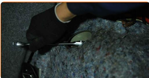
**33** Nettoyez les fixations de l'amortisseur. Utilisez de la graisse au cuivre.
