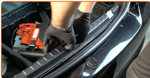
**6** Dévissez la fixation de la garniture latérale du coffre. Utilisez un outil d'extraction de clips. Utilisez la mèche Torx T40. Utilisez une clé à cliquet.
