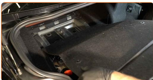
**4** Dévissez la fixation du panneau de protection central en plastique. Servez-vous d'un tournevis Phillips. Utilisez un outil d'extraction de clips. Utilisez la mèche Torx T40. Utilisez une clé à cliquet.
