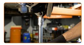
Serrez la fixation reliant la barre stabilisatrice au bras de suspension. Utilisez une douille n° 13. Utilisez une clé dynamométrique. Serrez-le jusqu'à 27 Nm.
