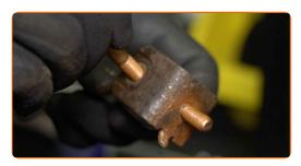
Vissez les fixations du support de la bielette de stabilisation. Utilisez une douille n° 13. Utilisez une clé à cliquet.
