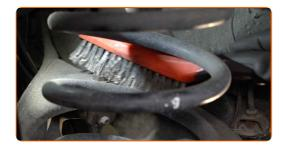
Dévissez la fixation reliant la barre stabilisatrice au bras de suspension. Utilisez une douille n° 13. Utilisez une clé à cliquet.
