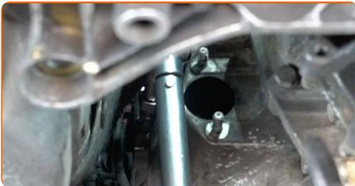
**70** Serrez les fixations qui relient la boîte de transmission au bloc-moteur. Utilisez la mèche Torx E14. Utilisez une clé dynamométrique. Serrez-le jusqu'à 72 Nm.
