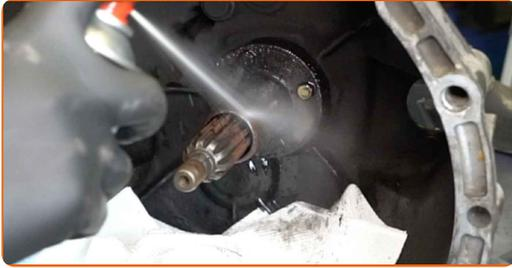
**59** Appliquez du produit sur l'emplacement de montage de la butée d'embrayage. Servez-vous d'une graisse multi-usages.
