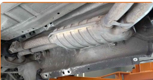
**86** Serrez les fixations de l'écran thermique d'échappement. Utilisez une douille n° 10. Utilisez une clé à cliquet.
