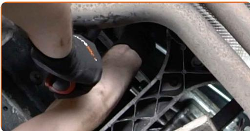
**71** Serrez les fixations inférieures qui relient la boîte de vitesses au moteur. Utilisez la mèche Torx E11. Utilisez une clé dynamométrique. Serrez-le jusqu'à 22 Nm.
