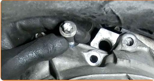
**68** Vissez les fixations qui relient la boîte de transmission au bloc-moteur. Utilisez la mèche Torx E14. Utilisez une clé à cliquet.
