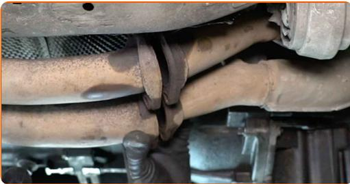
**88** Serrez les fixations du système d'échappement. Utilisez une douille n° 13. Utilisez une clé dynamométrique. Serrez-le jusqu'à 22 Nm.
