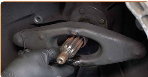
**58** Nettoyez le siège de montage de la butée d'embrayage. Servez-vous d'un aérosol nettoyant multi-usages.
