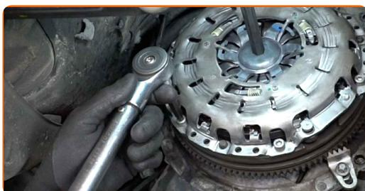
54 Dévissez la plaque de verrouillage de la plaque de pression. Utilisez la clé HEX n° H14. Utilisez une clé à cliquet.
