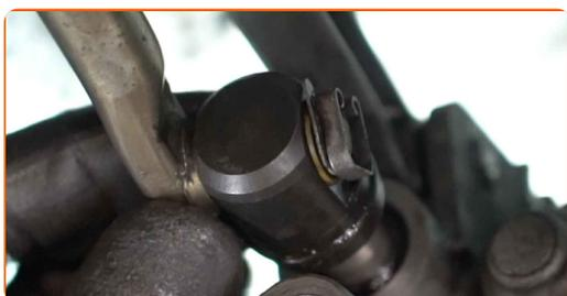
**77** Raccordez l'arbre de transmission à la bride de la boîte de vitesses via l'accouplement de l'arbre de transmission.
