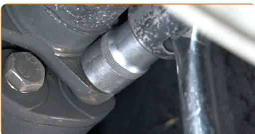
14 Dévissez les fixations du cylindre récepteur d'embrayage. Utilisez une douille n° 13. Utilisez une clé à cliquet.
