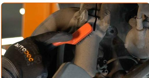
**35** Relâchez la fixation inférieure assurant la connexion entre la jambe d'amortisseur et le porte-fusée. Servez-vous d'une douille spéciale pour retirer l'amortisseur.
