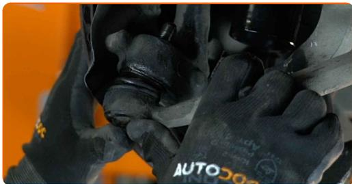
**69** Vissez l'écrou de fixation reliant l'embout de biellette à la fusée d'essieu. Utilisez une clé mixte de No.18
