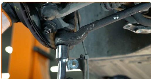
**68** Connectez l'extrémité du tirant à la fusée d'essieu.
