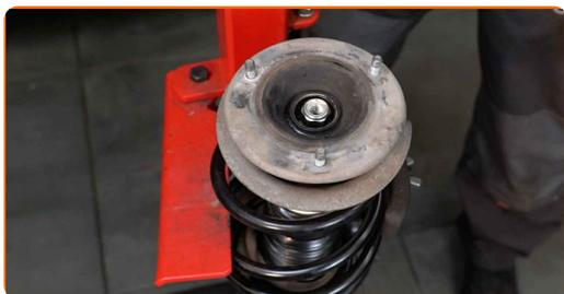
**53** Serrez l'écrou de l'entretoise d'amortisseur due la tige de piston. Utilisez une douille n° 22. Utilisez la clé HEX n° H6. Utilisez une clé dynamométrique. Serrez-le jusqu'à 64 Nm.
