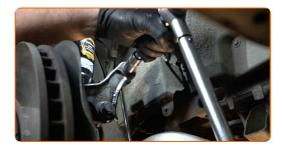
Serrez la fixation reliant la biellette à la barre stabilisatrice. Utilisez une douille n° 16. Utilisez une clé dynamométrique. Serrez-le jusqu'à 65 Nm.
