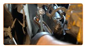
Resserez la fixation de la biellette de la barre stabilisatrice. Utilisez une douille n° 16. Utilisez une clé à cliquet.
