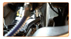
Serrez la fixation reliant la biellette à l'amortisseur. Utilisez une douille n° 16. Utilisez une clé dynamométrique. Serrez-le jusqu'à 65 Nm.
