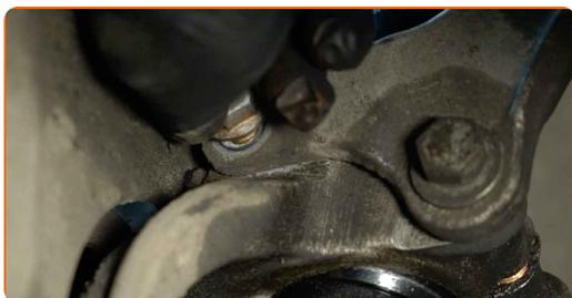
**69** Vissez la fixation qui relie la jambe d'amortisseur à la fusée d'essieu. Utilisez une douille n° 18. Utilisez une clé à cliquet.
