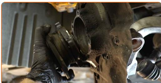
**35** Nettoyez l'emplacement de roulement de moyeu. Utilisez une brosse métallique. Servez-vous d'un aérosol nettoyant multi-usages.
