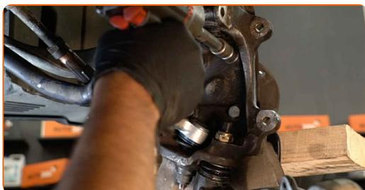
**34** Retirez le moyeu et le roulement puisqu'ils forment un bloc hermétique.
