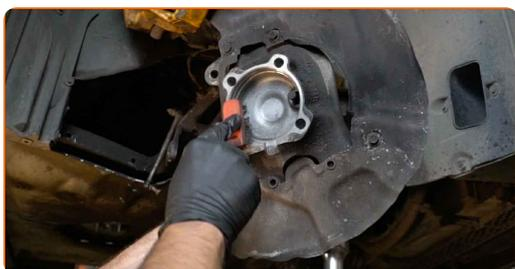
**36** Installez le nouveau moyeu de roue avec un roulement.
