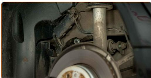
**12** Dévissez la fixation reliant le bras de contrôle à l'essieu arrière. Utilisez une clé mixte de No.21 Utilisez une douille n° 10. Utilisez une clé à cliquet.
