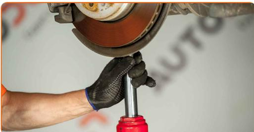
**22** Serrez la fixation avant reliant le bras de commande au sous-châssis. Utilisez une clé mixte de No.18 (2 pièces). Utilisez une clé dynamométrique. Serrez-le jusqu'à 100 Nm.
