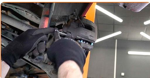
**20** Installez les bouchons anti-poussière des goupilles de guidage de l'étrier de frein.
