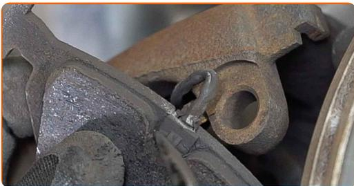
**19** Installez l'étrier de frein et fixez-le. Utilisez la clé HEX n° H7. Utilisez une clé dynamométrique. Serrez-le jusqu'à 30 Nm.
