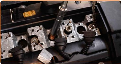
19 Vissez les nouvelles bougies et serrez-les. Servez-vous de la douille de bougie d'allumage n°16. Utilisez une clé dynamométrique. Serrez-le jusqu'à 24 Nm.
