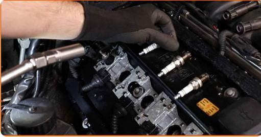
17 Appliquez une fine couche d'antigrippant à haute température sur les fils des nouvelles bougies d'allumage.
