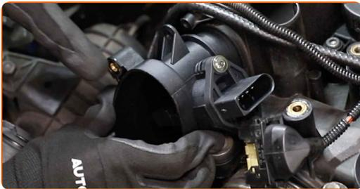
23 Serrez les fixations du capteur de débit massique (MAF). Utilisez la mèche Torx T25. Utilisez une clé dynamométrique. Serrez-le jusqu'à 8 Nm.
