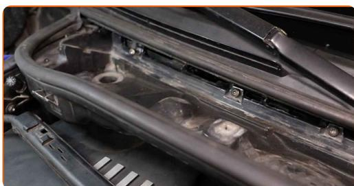
**35** Vissez les fixations du boîtier du filtre d'habitacle. Utilisez la mèche Torx T30. Utilisez une clé à cliquet.
