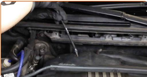
**33** Réinstallez l'ensemble du boîtier de distribution d'air.
