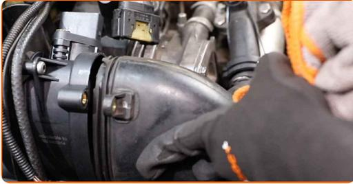
26 Serrez les fixations qui relient la conduite d'air au capteur de débit de masse d'air. Utilisez la clé HEX n° H5. Utilisez une clé dynamométrique. Serrez-le jusqu'à 5 Nm.
