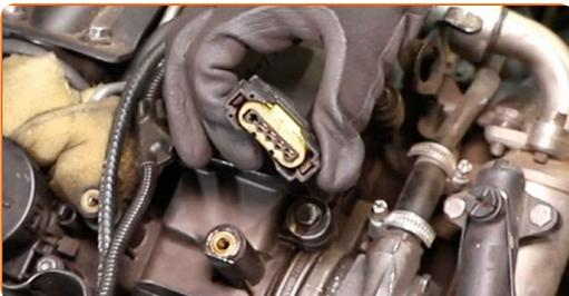
20 Dévissez les fixations du capteur de débit massique (MAF). Utilisez la mèche Torx T25. Utilisez une clé à cliquet.
