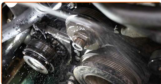
**41** Mettez de côté la poulie de tendeur de la courroie en V crantée. Utilisez une clé mixte de No.26
