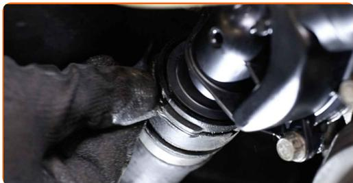
**40** Nettoyez les sièges de montage de la courroie trapézoïdale. Servez-vous d'un aérosol nettoyant multi-usages.
