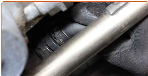
**24** Desserrez le collier de serrage du tuyau de refroidissement.
