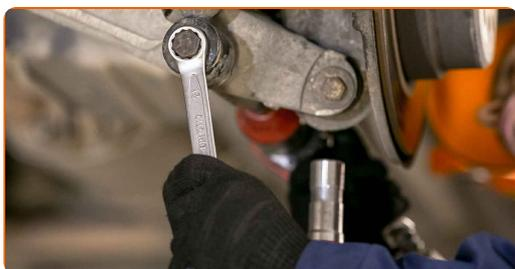
**8** Retirez l'écrou de fixation.
