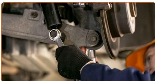
**45** Nettoyez les fixations de l'amortisseur. Utilisez de la graisse au cuivre.
