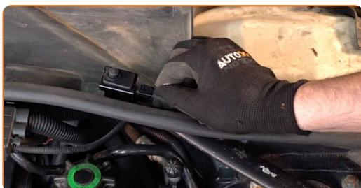
**32** Attachez les fixations de la partie supérieure du boîtier pour microfiltre.
