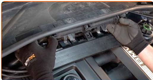
**29** Attachez les câbles électriques de la partie supérieure du boîtier pour microfiltre.
