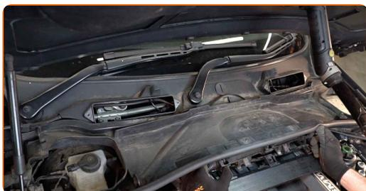
**28** Attachez le conduit de câbles de la partie supérieure du boîtier pour microfiltre.
