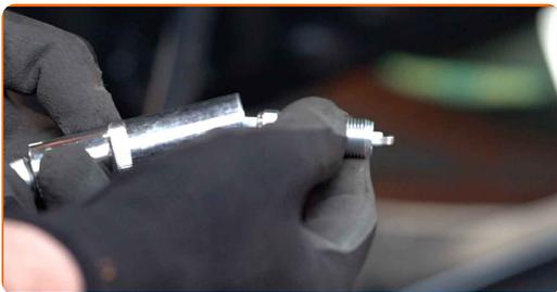
**20** Vissez les nouvelles bougies et serrez-les. Servez-vous de la douille de bougie d'allumage n°16. Utilisez une clé dynamométrique. Serrez-le jusqu'à 27 Nm.
