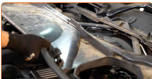
**12** Dévissez les attaches du cache moteur. Utilisez la clé HEX n° H5. Utilisez une clé à cliquet.
