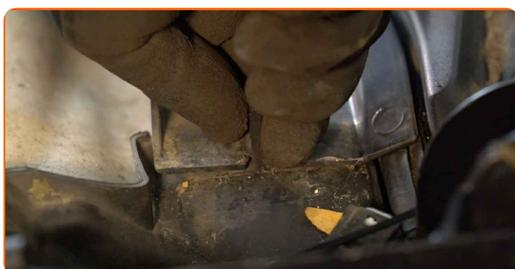
**10** Détachez le conduit de câbles de la partie supérieure du boîtier pour microfiltre. Utilisez un tournevis plat.
