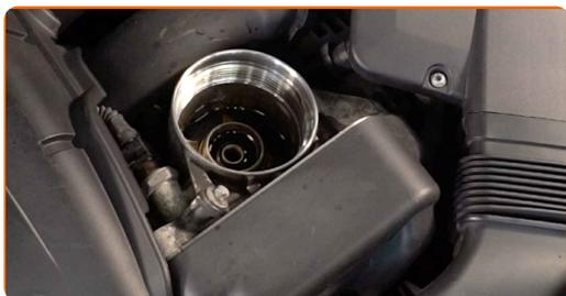
**26** Lubrifiez le joint en caoutchouc du nouveau filtre avec une petite quantité d'huile neuve.
