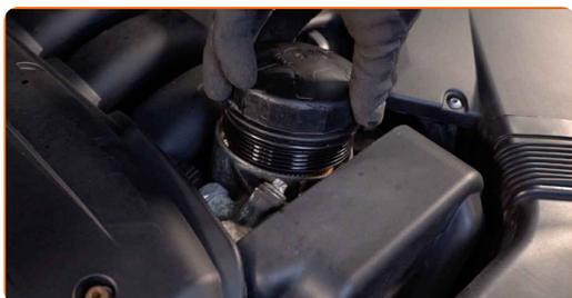
**28** Installez un nouveau couvercle de compartiment à filtre à huile, et serrez. Utilisez la douille 86-16F. Utilisez une clé dynamométrique. Serrez-le jusqu'à 25 Nm.
