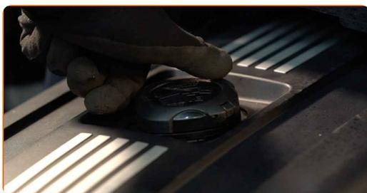
**4** Dévissez le bouchon du compartiment du filtre, ainsi que l'ancien élément filtrant. Utilisez la douille 86-16F. Utilisez une clé à cliquet.
