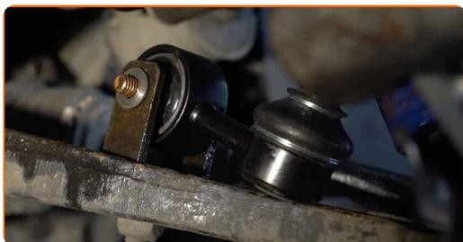
**13** Installez l'écrou de fixation.
