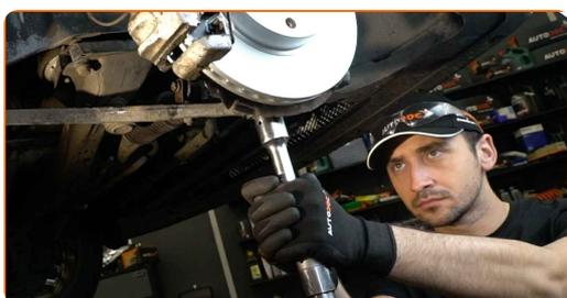
**16** Serrez la fixation reliant la barre stabilisatrice au bras de suspension. Utilisez une clé mixte de No.17 Utilisez une douille n° 17. Utilisez une clé dynamométrique. Serrez-le jusqu'à 42 Nm.
