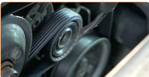
**10** Mettez de côté la poulie de tendeur de la courroie en V crantée. Utilisez une douille n° 16. Utilisez une clé à cliquet.
