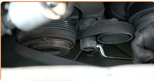
**9** Retirez le bouchon de la poulie de tension.
