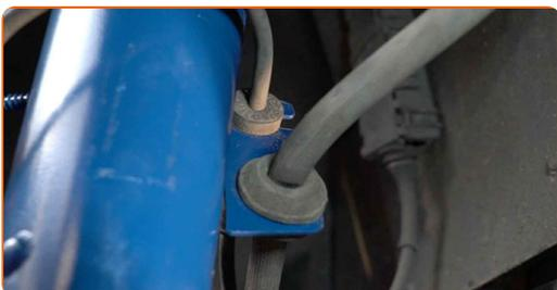
**42** Appliquez du produit sur les fixations de l'amortisseur. Utilisez de la graisse au cuivre.
