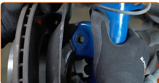
**36** Installez les boulons de fixation.
