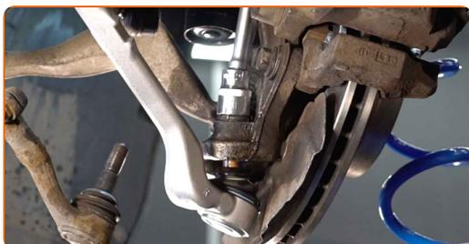
**21** Appliquez du produit sur la fixation reliant l'embout de biellette de direction à la fusée d'essieu. Utilisez de la graisse au cuivre.
