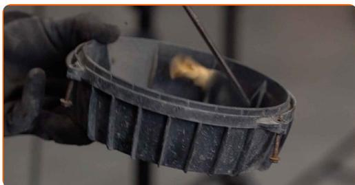
**Remplacement : filtre à air – Fiat Bravo 2. AUTODOC recommande :**
