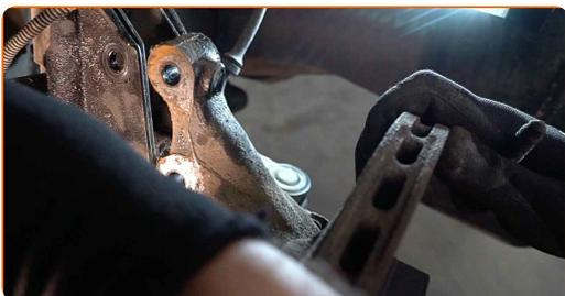
**18** Dévissez l'attache supérieure du support de l'amortisseur. Utilisez une douille n° 19. Utilisez une clé à cliquet.
