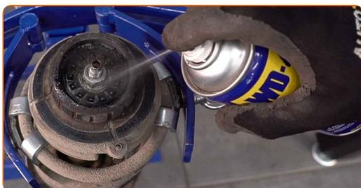
**23** Retirez l'écrou de la tige de piston de l'entretoise. Utilisez une clé mixte de No.19 Utilisez la clé HEX n° H6. Utilisez une clé à cliquet.
