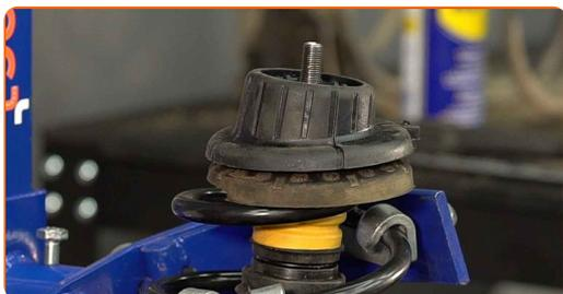
**30** Serrez l'écrou de l'entretoise d'amortisseur due la tige de piston. Utilisez une clé mixte de No.19 Utilisez la clé HEX n° H6. Utilisez une clé dynamométrique. Serrez-le jusqu'à 60 Nm.
